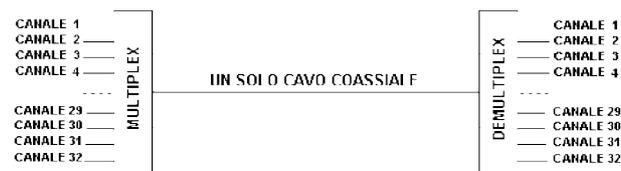
Il **PCM** si applica ai canali telefonici e, il tipo europeo, consente di far transitare su **un solo cavo coassiale 32 telefonate** contemporaneamente, senza interferenze, e indirizzarle, in ricezione ciascuna all'utente richiesto. Dei **32 canali**, **30** sono canali vocali e **2** sono canali di servizio. Per realizzare la tecnica **PCM** si effettuano tre operazioni a partire dal segnale di partenza:
